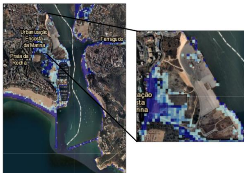
Figura 6.2.5 - Zonas com probabilidade de inundação em situação extrema em 2050 no local do projeto (Rocha et al., 2018).
